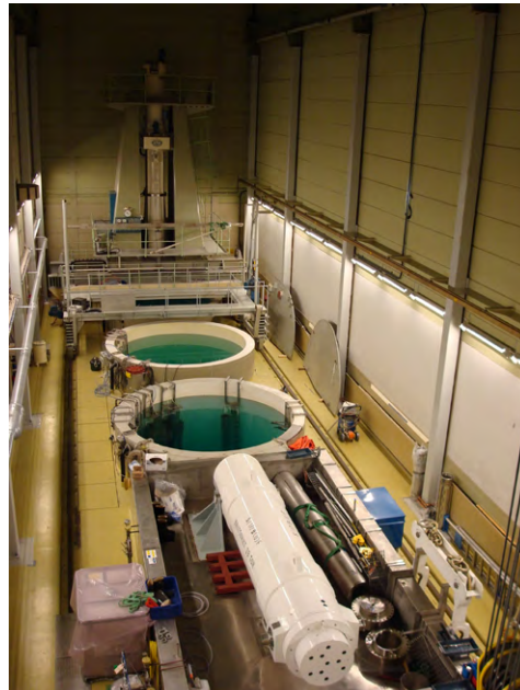
Abbildung 2: Blick in die Halle der Firma Studsvik, in welcher die für SMILE gewonnenen Proben in acht Meter tiefen Tanks gelagert werden. Im Vordergrund ein 29 Tonnen schwerer Transportbehälter. (Bild: Studsvik)
