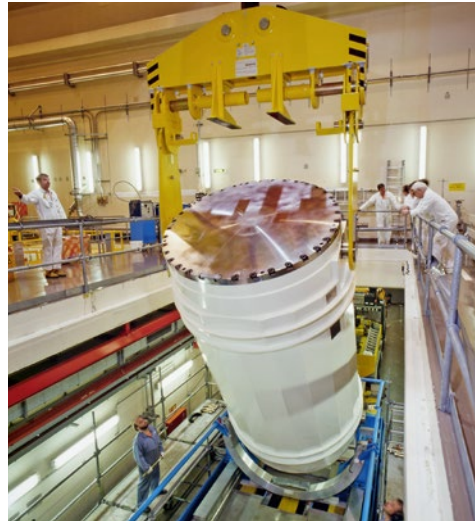
Umladen eines Transport- und Lagerbehälters. Foto: KKL
