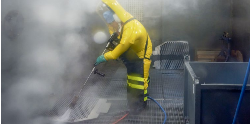
Materialbehandlung in der Nassstrahl- Dekontaminations- box. Foto: BKW
