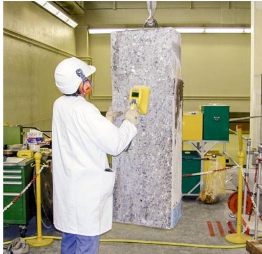
**Bild 21:** Freimessungen an nicht aktivierten Betonblöcken aus dem Rückbau des Forschungsreaktors Saphir.
