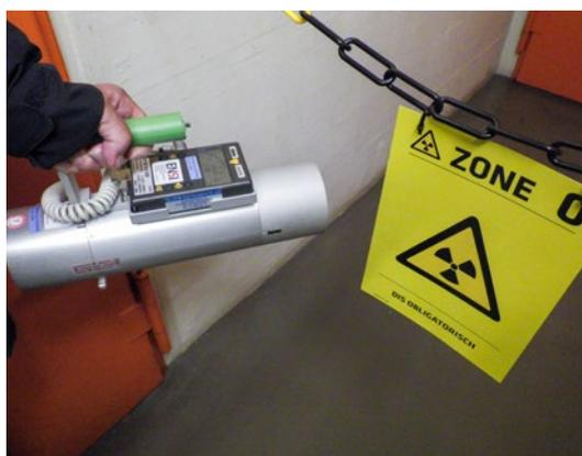
**Bild 1:** ENSI-Inspektor bei der Kontrolle der Ortsdosisleistung an der Grenze einer kontrollierten Zone.
