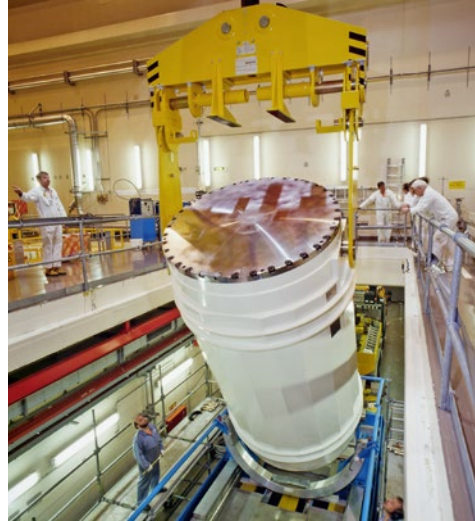
Umladen eines Transport- und Lagerbehälters. Foto: KKL
