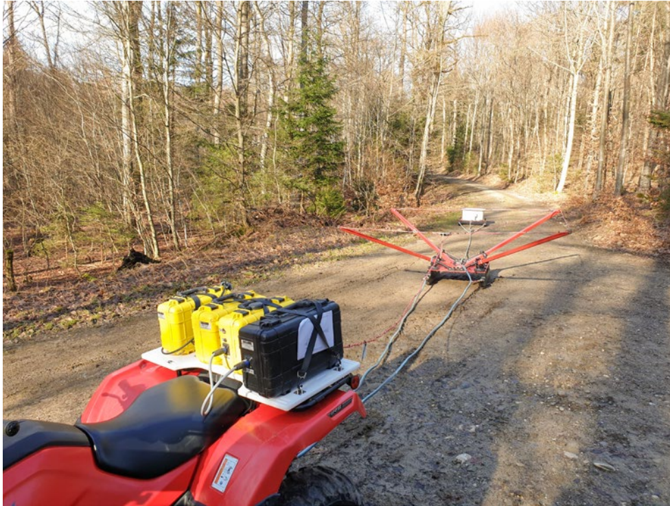
Abbildung 39: tTEM-Messungen auf dem Irchel-Plateau. Im Januar 2024 wurden ca. 40 km, also nahezu alle Fahrwege und Rückgassen auf dem Irchel-Plateau, mit dem innovativen Verfahren towed Timedomain-Electro Magnetics (geschleppte, zeitbasierte Elektromagnetik) untersucht. Bei diesem geophysikalischen Verfahren wird über ein Spulensystem (Wäschespinnensystem-artige Konstruktion im Bild) ein Magnetfeld im Untergrund erzeugt. Dieses verursacht dort in elektrisch leitfähigen Schichten (beispielsweise wasserführenden Schottern und Sanden) ein sekundäres Magnetfeld, welches wiederum mit einem hochempfindlichen Messgerät an der Oberfläche (grauer Kasten im Hintergrund) empfangen wird. Das Messsystem wurde für die Arbeiten exklusiv von der Entwicklerfirma TEM Company aus Dänemark auf den Irchel gebracht. (Bild: A. Dehnert, ENSI)
