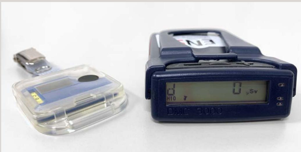
**Bild 4:** Personen, die bei ihrer Arbeit in Kernanlagen als strahlenexponiert gelten, müssen zwei verschiedene Dosis-Messgeräte tragen: Links im Bild ein passives Dosimeter, rechts ein aktives Dosimeter.
