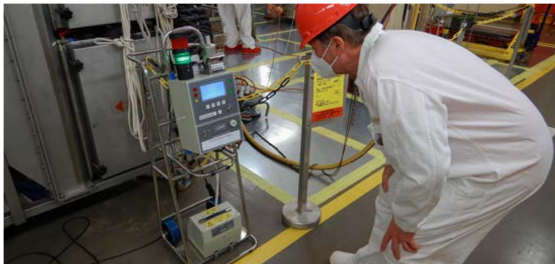
Bild 11: Ein Inspektor des ENSI über- prüft im KKW Leibstadt die aktuellen Messwerte der Raumluft- überwachung in der Nähe einer Filter- anlage.
