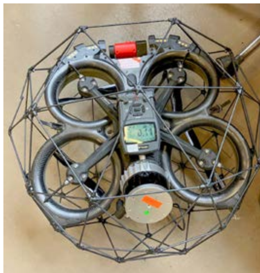
Bild 3: Drohne mit Wärme- bildkamera und Dosis- leistungs- messgerät.
