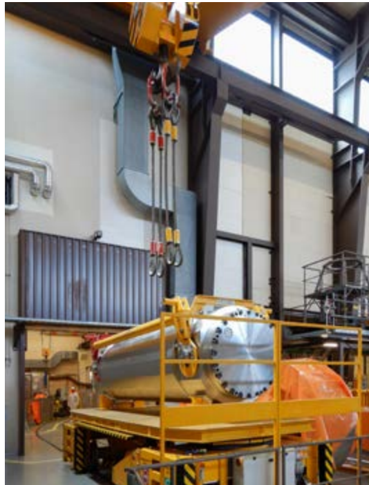
Bild 23: Innerbetrieblicher Transport des Behälters mit den Brennelementen während einer Abtransportkampagne.
