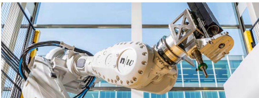
Bild 6: Roboter mit Ultraschall-Schweisswerkzeug.
