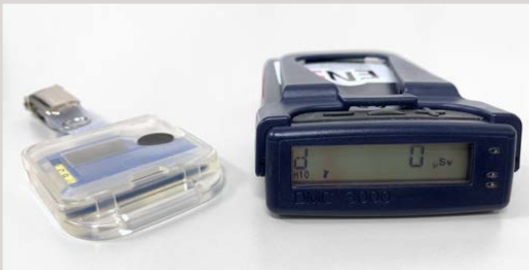
Bild 13: Personen, die bei ihrer Arbeit in Kernanlagen als strahlenexponiert gelten, müssen zwei verschiedene Dosis-Messgeräte tragen: Links im Bild ein passives Dosimeter, rechts ein aktives Dosimeter.
