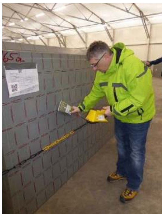
Bild 16: Mitarbeiter des ENSI bei einer Befreiungsmessung.
