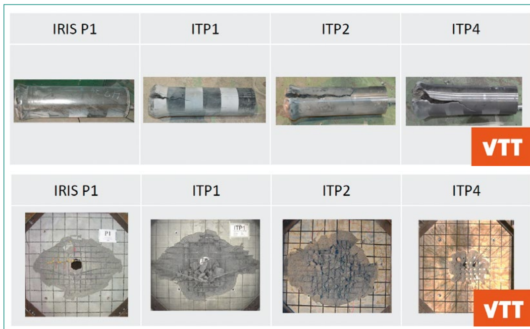
Abbildung 1: Verformte Projektile (oben) und Schädigungen auf der Plattenrückseite (unten), Quelle: VTT
