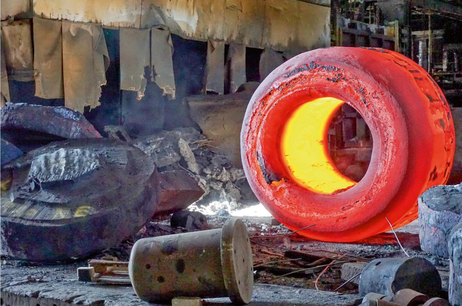
*Ebauche de la réplique de la virole C de la cuve de pression du réacteur 1 de la centrale nucléaire de Beznau (photo KKB)*
