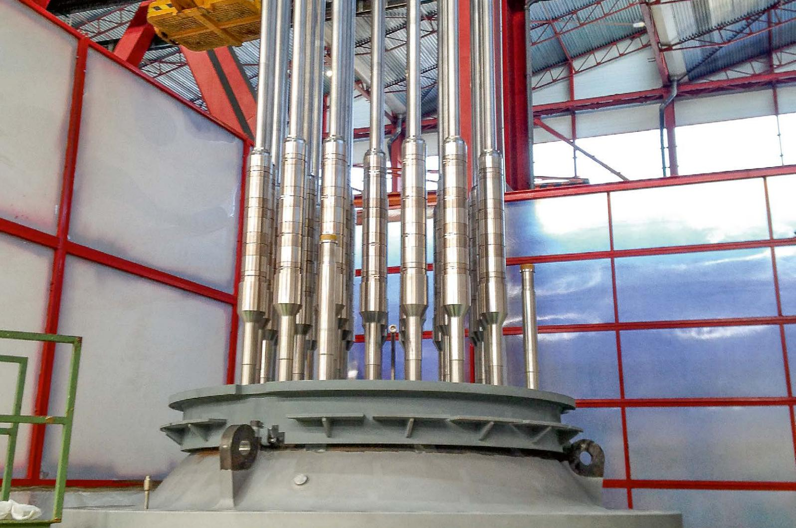
Nouveau couvercle de la cuve d'un réacteur avec ses systèmes de commande de grappes de contrôle (photo KKB)
