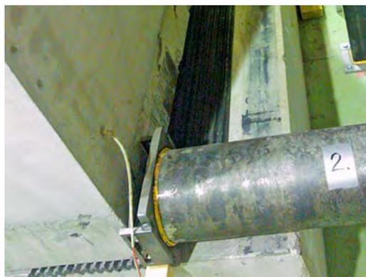
Abbildung 2: Test V1, Horizontallager an der Rückseite des Versuchskörpers, Quelle: VTT
