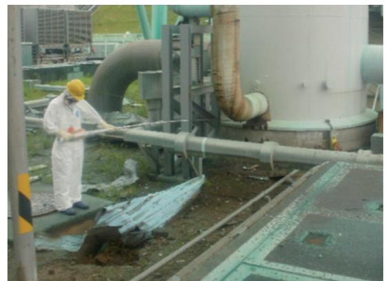
Fig. 3-7 Pied de cheminée entre les tranches 1 et 2, mesure au moyen d'un détecteur télescopique <sup>20</sup>
