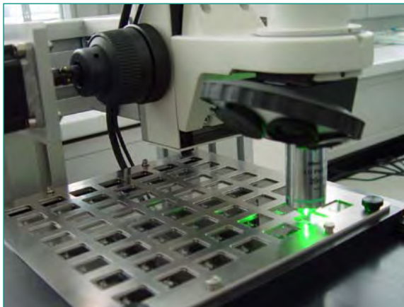
Abbildung 3: TASL-Auswertesystem mit Mikroskop und Objekt-Tisch (links) sowie Steuereinheit und PC (rechts).
