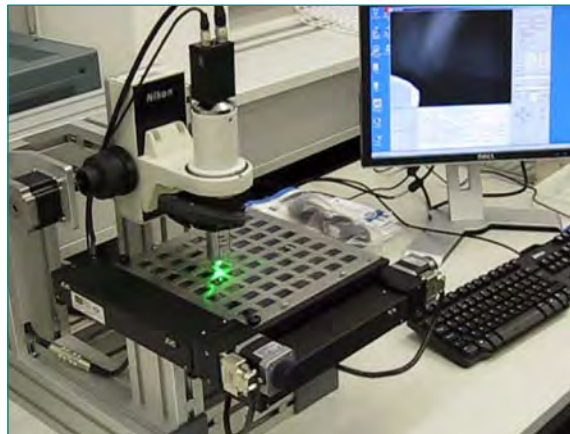
Abbildung 3: TASL-Auswertesystem mit Mikroskop und Objekt-Tisch (links) sowie Steuereinheit und PC (rechts).
