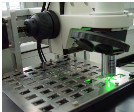
Figur 6: Auswertung des Detektormaterials CR-39 mittels computergestützter Bildanalyse und digitaler Mikroskopie. Dazu wird das hier gezeigte TASL-System mit Mikroskop und Objekt-Tisch verwendet (Quelle: PSI).
