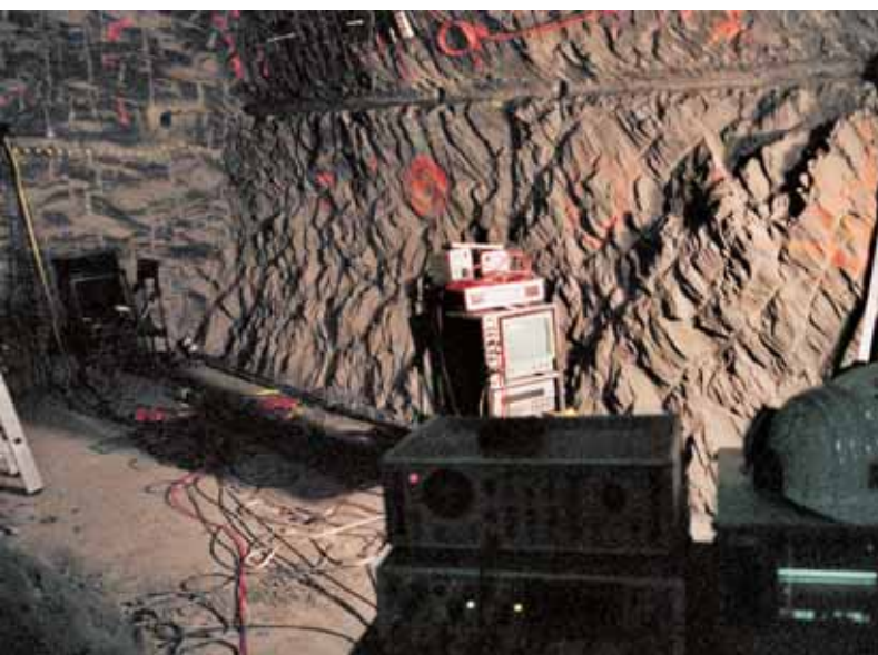
Blick auf die rechte Stollenwand des EZ-B-Teststollens. Deutlich erkennbar ist die Spur der vorgängig abgeteufte horizontalen Beobachtungsbohrung sowie das Interferenzmuster von Trennflächengefüge und Schichtung im Opalinuston.
