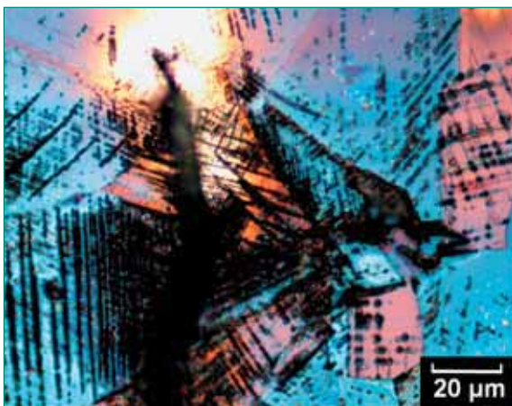
Bild 18: TP 321H, ermüdet: T = 30\text{ }^{\circ}\text{C} , D = 1.0 , N = 53\,920 . Radialschliff, geätzt: Spitze des Hauptrisses mit Gleitbändern in der angrenzenden Grundmasse, deren Verlauf durch die Anzeigen von Martensit (dunkel) gegeben ist.
