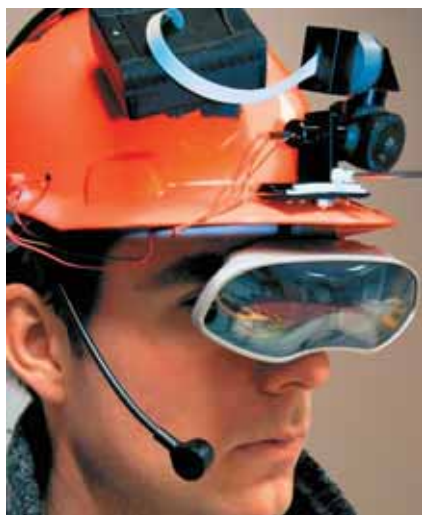
Halden Virtual Reality (VR) Lab. Die Visualisierungstechnologie macht Strahlenfelder sichtbar. Quelle: OECD Halden Reactor Project.
