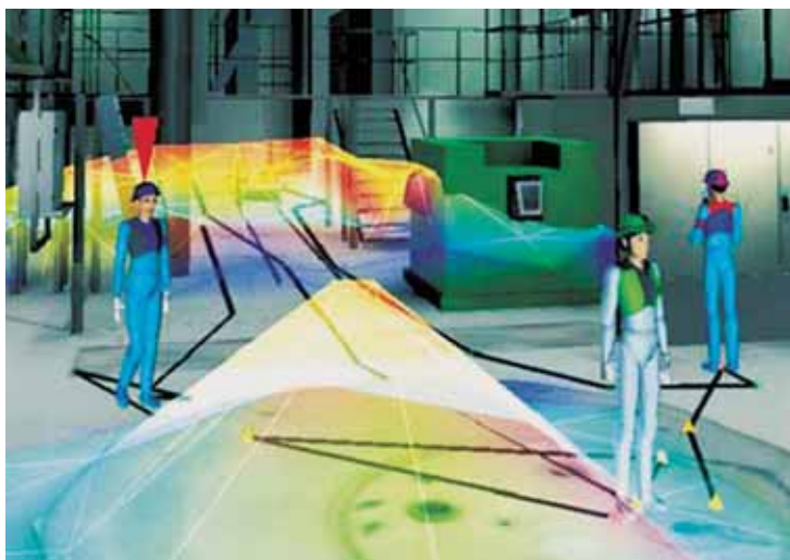
Halden Virtual Reality (VR) Lab. Die Visualisierungstechnologie macht Strahlenfelder sichtbar. Quelle: OECD Halden Reactor Project.
