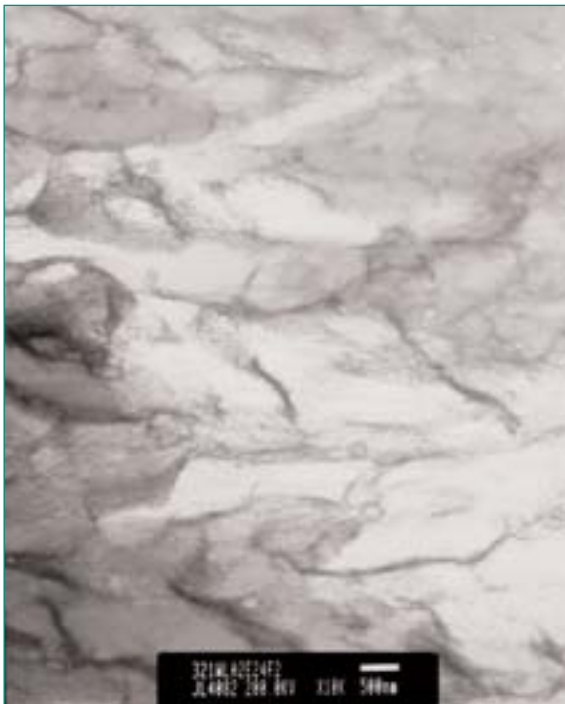
Abb. 21: Dünnschliff der niederzyklisch ermüdeten Probe aus dem Plattenmaterial: \Delta\varepsilon_f/2 = 0.30\% ; R_e = -1 ; T = 100^\circ\text{C} ; f = 0.5\text{ Hz} ; D = 0.60 ; N = 14\,200 ; c_{\alpha'}(ND) = 4.8\% . TEM-Aufnahme, Hellfeld: Zellartige Versetzungsstruktur in einem Austenitkorn.
