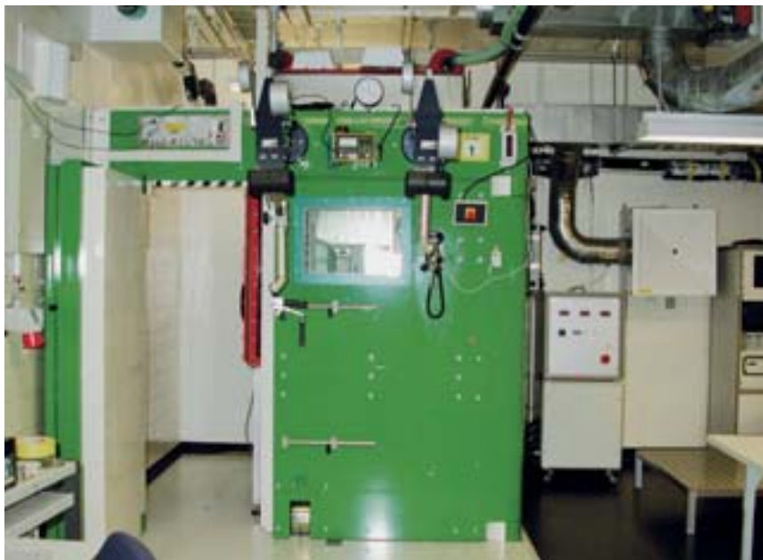
Strahlabschirmung (grün) der neuen Zugversuchsanordnung für bestrahlte Materialproben im Hotlabor des PSI. Foto: PSI
