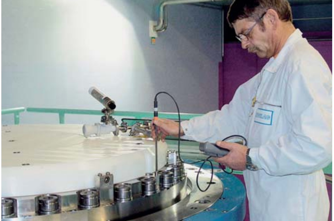
Transport- und Lagerbehälter für verglaste, hochradioaktive Abfälle: Temperaturkontrolle während Dichtheitsprüfung. Foto: ZWILAG
