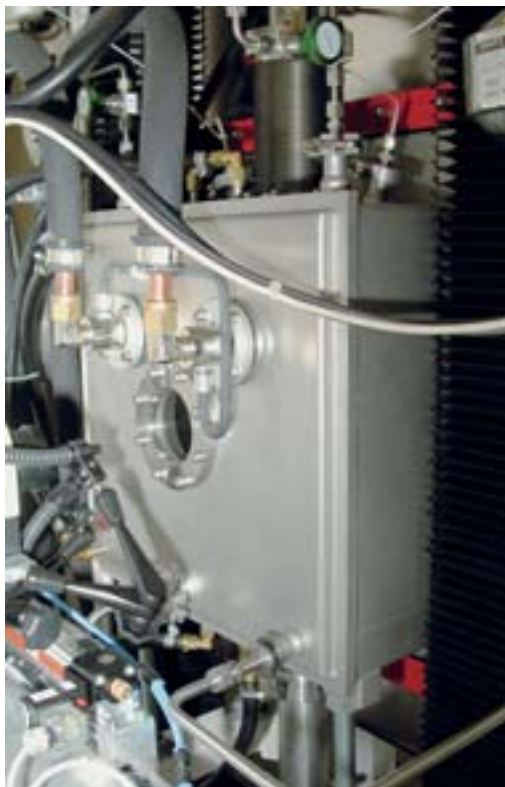
Rückseite der Vakuummutter mit Heizstromanschlüssen für den Ofen, in dessen Zentrum bestrahlte Materialproben Zugversuchen ausgesetzt werden. Foto: PSI
