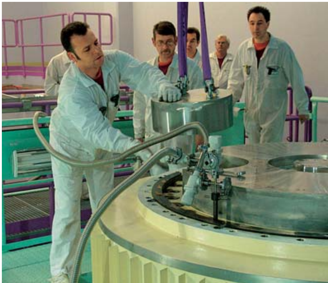
Transport- und Lagerbehälter für verglaste hochradioaktive Abfälle: Abheben des Abschirmstopfens des Primärdeckeldurchbruchs. Foto: ZWILAG
