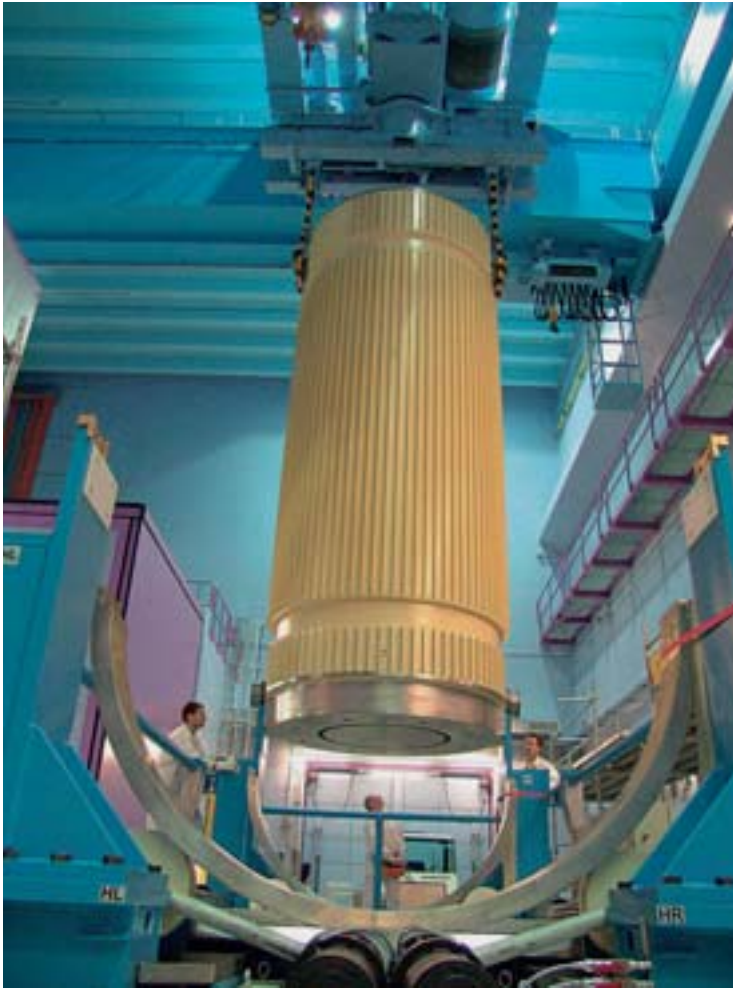
Transport- und Lagerbehälter für verglaste hochradioaktive Abfälle im ZWILAG-Empfangsgebäude. Foto: PSI
