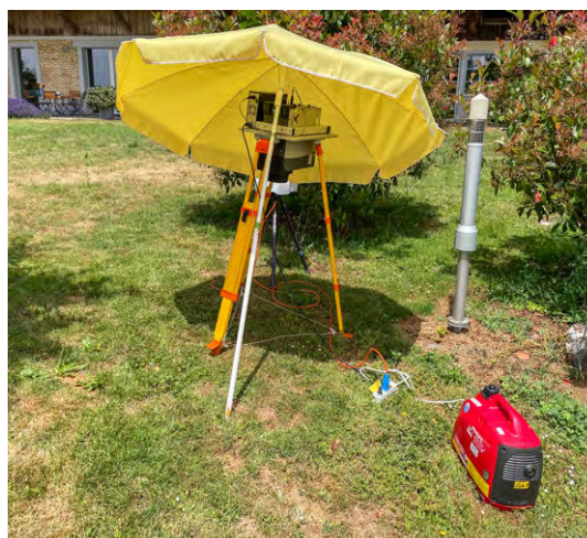
Bild 21: Immissionsmessungen des ENSI mit Sonnenschutz für den Detektor.
