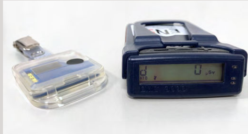
Bild 2: Personen, die bei ihrer Arbeit in Kernanlagen als strahlenexponiert gelten, müssen zwei verschiedene Dosis-Messgeräte tragen: Links im Bild ein passives Dosimeter, rechts ein aktives Dosimeter.
