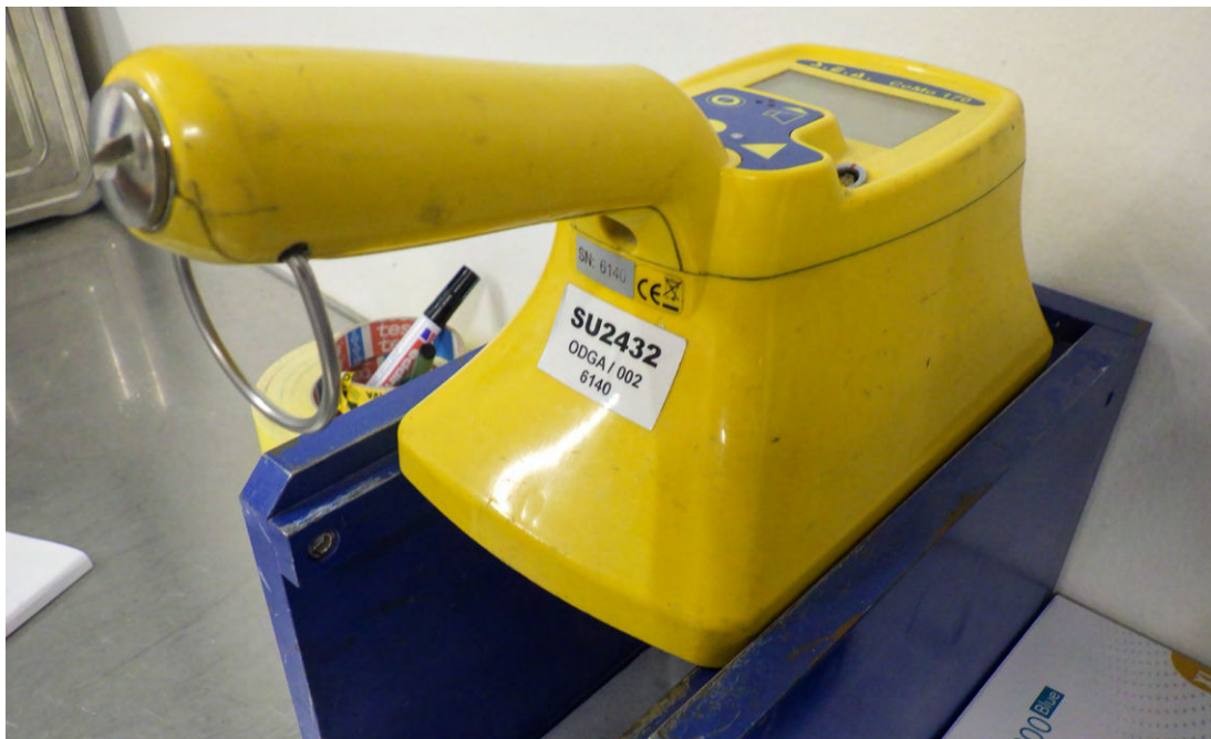
Bild 18: Messgerät des PSI Strahlenschutzes für Kontaminationmessungen am Ausgang einer kontrollierten Zone.
