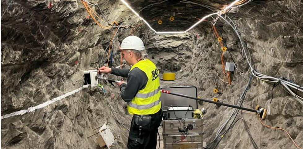
**Im Felslabor wird der Opalinuston untersucht als Wirtgestein für das Tiefenlager.
