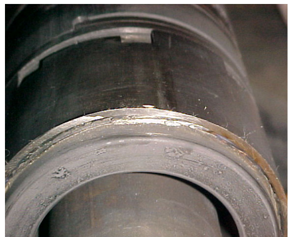
Abbildung 6: Vom «Klebeffekt» betroffene Oberfläche. Quelle: Nuclear Regulatory Agency (Bulgarien)
