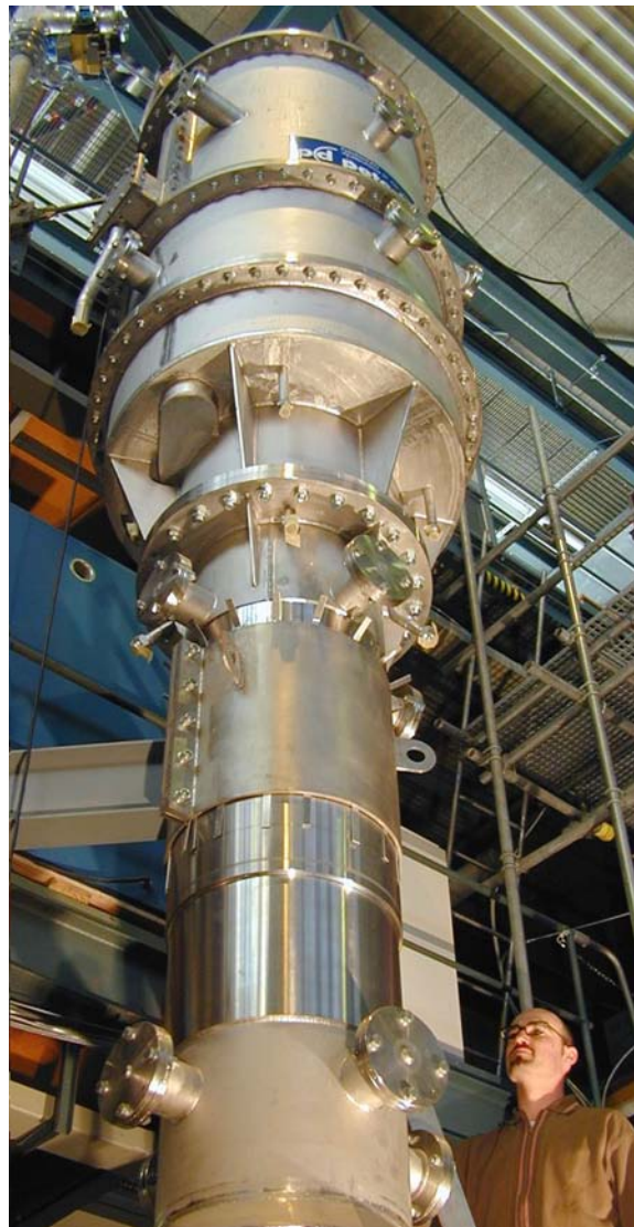
Oberer Teil der ARTIST-Teststrecke mit montiertem Tropfenabscheider- und Dampftrockner-Modul.
