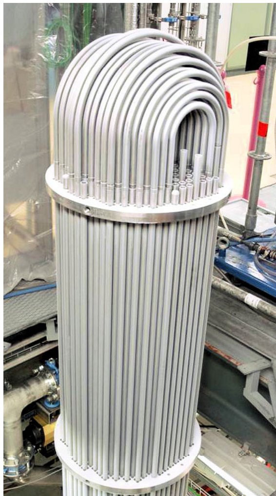
ARTIST-Rohrbündel nach einem Aerosoltest. Die Rohre sind mit einer Schicht von Aerosolen belegt, die sich im Test abgelagert haben und somit im Bündelbereich zurückgehalten wurden.
