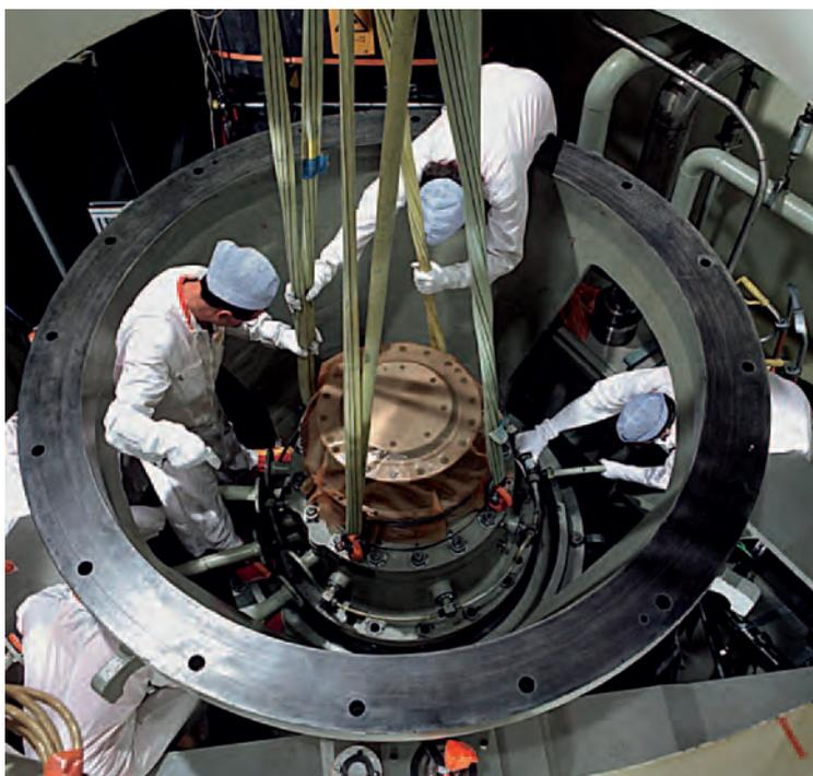
sind Rissanzeigen festgestellt worden. Sie wurden vorsorglich gegen neue Steuerelemente ausgetauscht. Alle anderen Steuerelemente befanden sich in einem auslegungsgemässen Zustand. Im 32. Betriebszyklus kommen 44 Steuerelemente aus Nachlieferungen sowie 4 aus der Erstausrüstung zum Einsatz.
