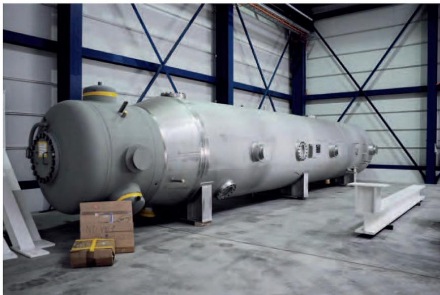
Der neue Niederdruckvorwärmer in der neu erstellten Grosskomponenten-Lagerhalle.
