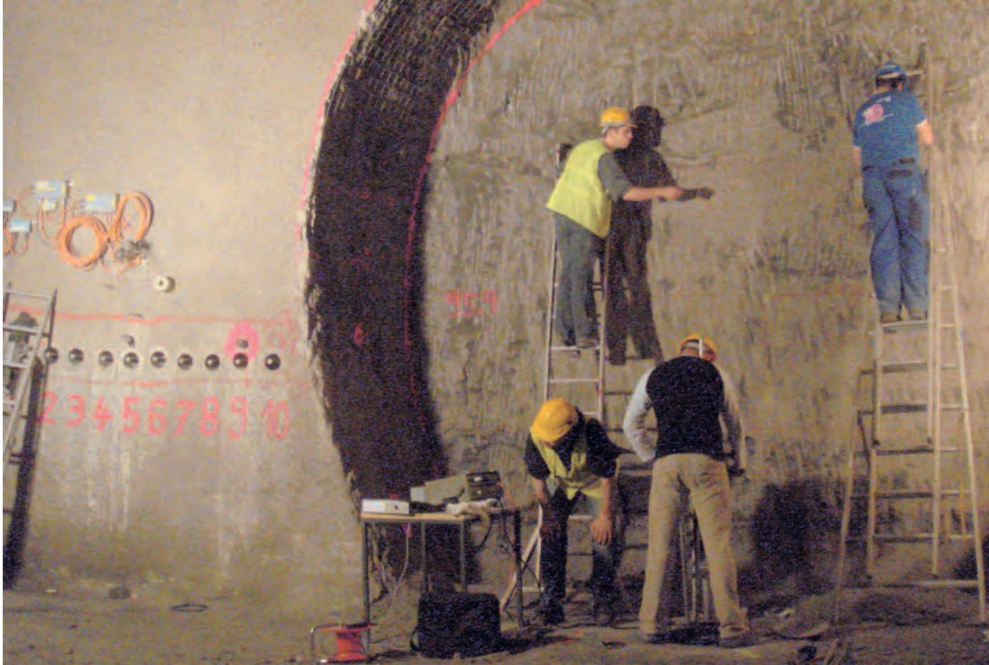
Montage von Versuchseinrichtungen im Felslabor Mont Terri.
