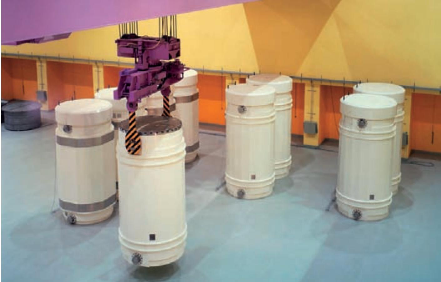
Ein Transport- und Lagerbehälter wird mit dem Kran in die Lagerhalle für hochaktive Abfälle gestellt.
