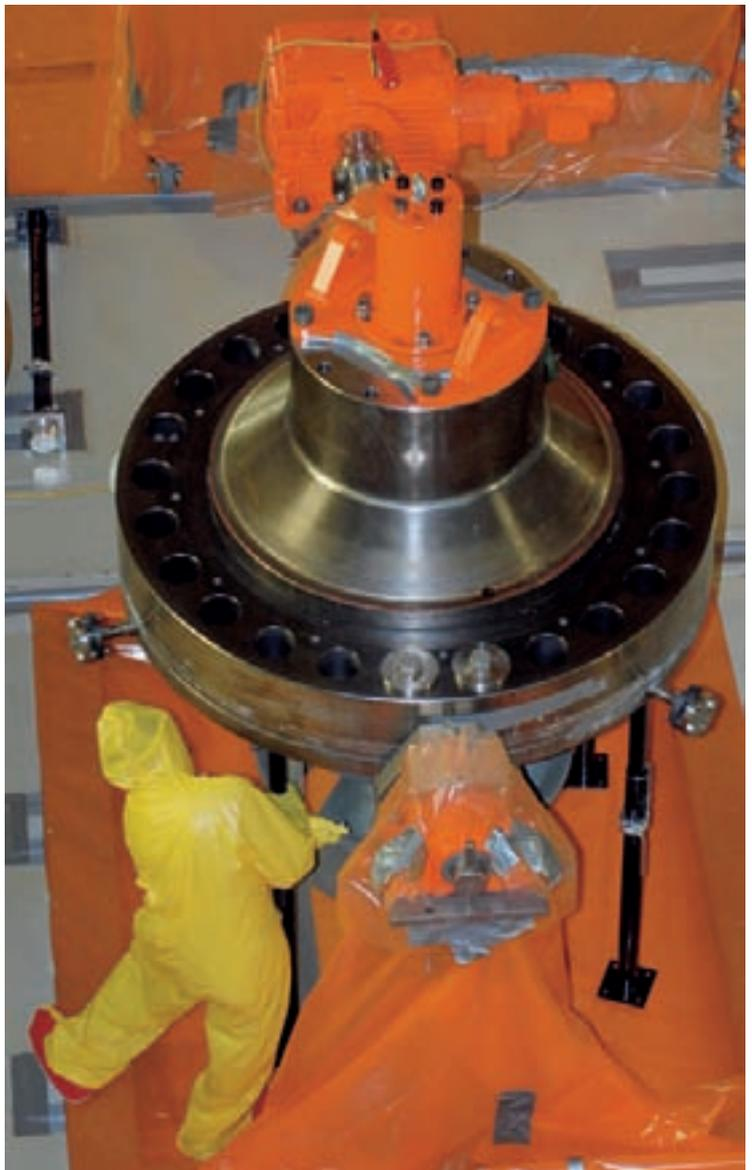
Das ausgebaute Schwungrad einer Hauptkühlmittelpumpe.
