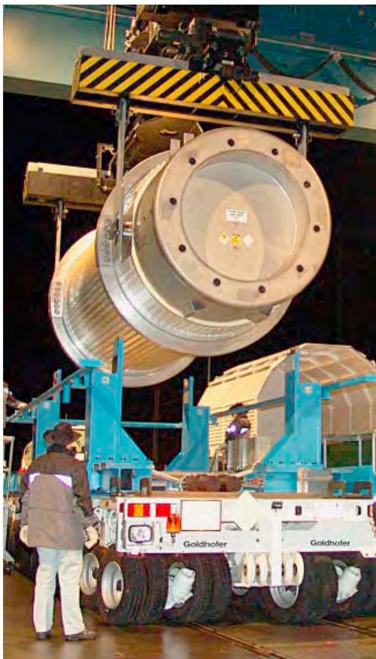
Umladen eines Transportbehälters von einem Schienen- auf ein Strassenfahrzeug Foto: Zwiilag
