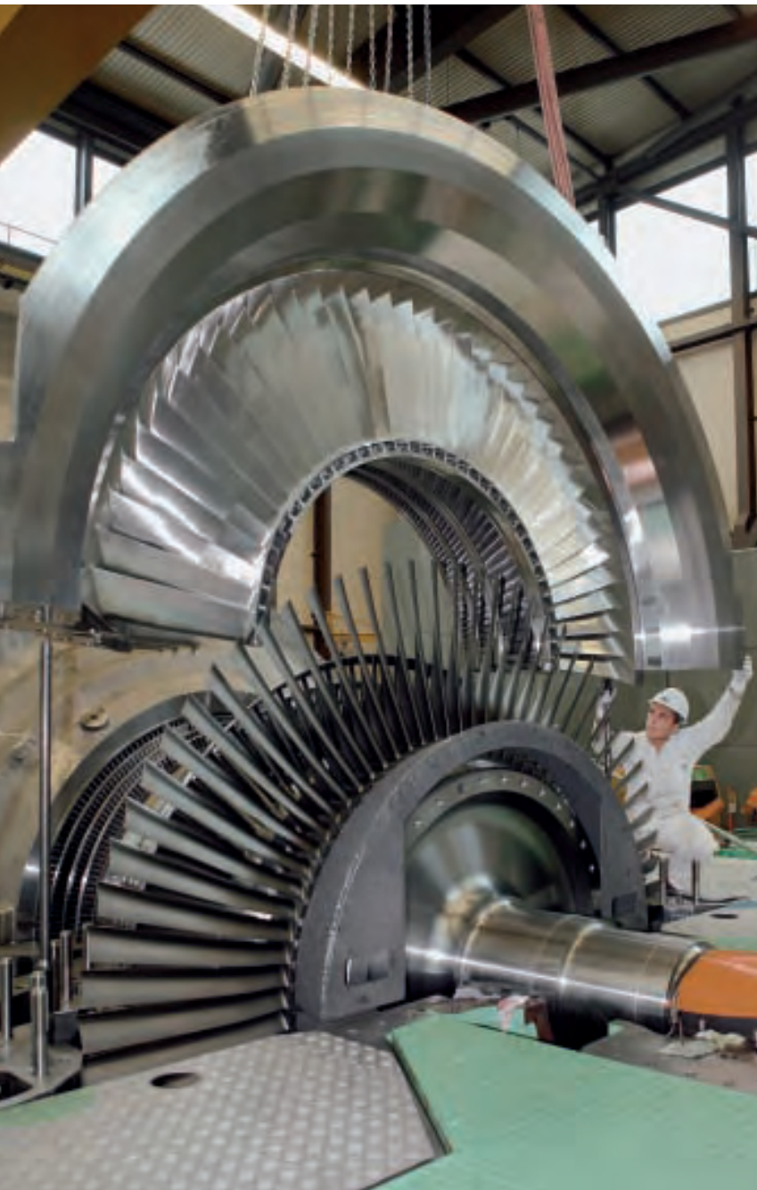
Zusammenbau einer Turbine Foto: KKM
