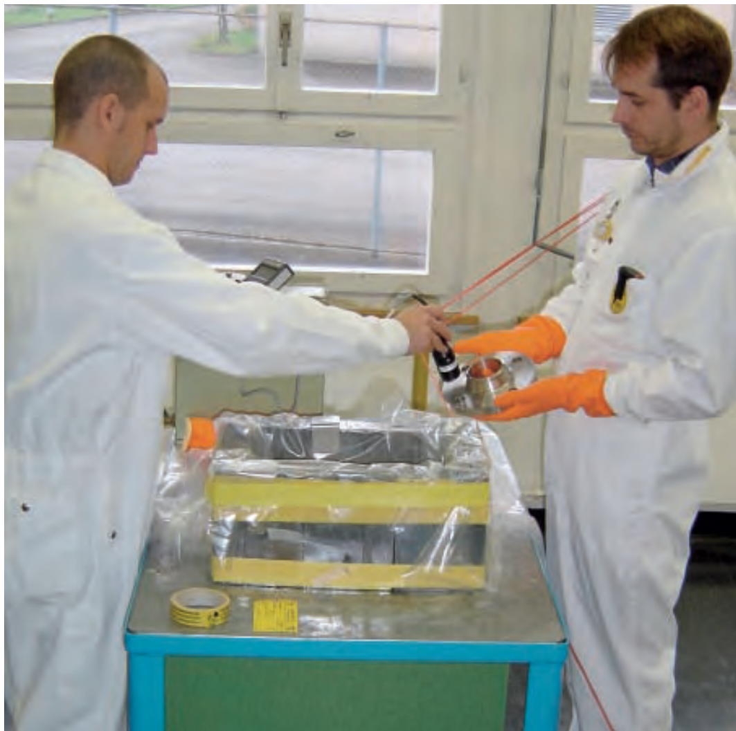
Die Überwachung des radioaktiven Zustands, hier die Kontaminationskontrolle von Material an der Zonengrenze, stellt eine wichtige Aufgabe des Strahlenschutzes dar. An der Strahlenschutzschule des PSI wird die Messung von Kontamination deshalb bei der praktischen Ausbildung von angehenden Strahlenschutzfachkräften intensiv geübt.
