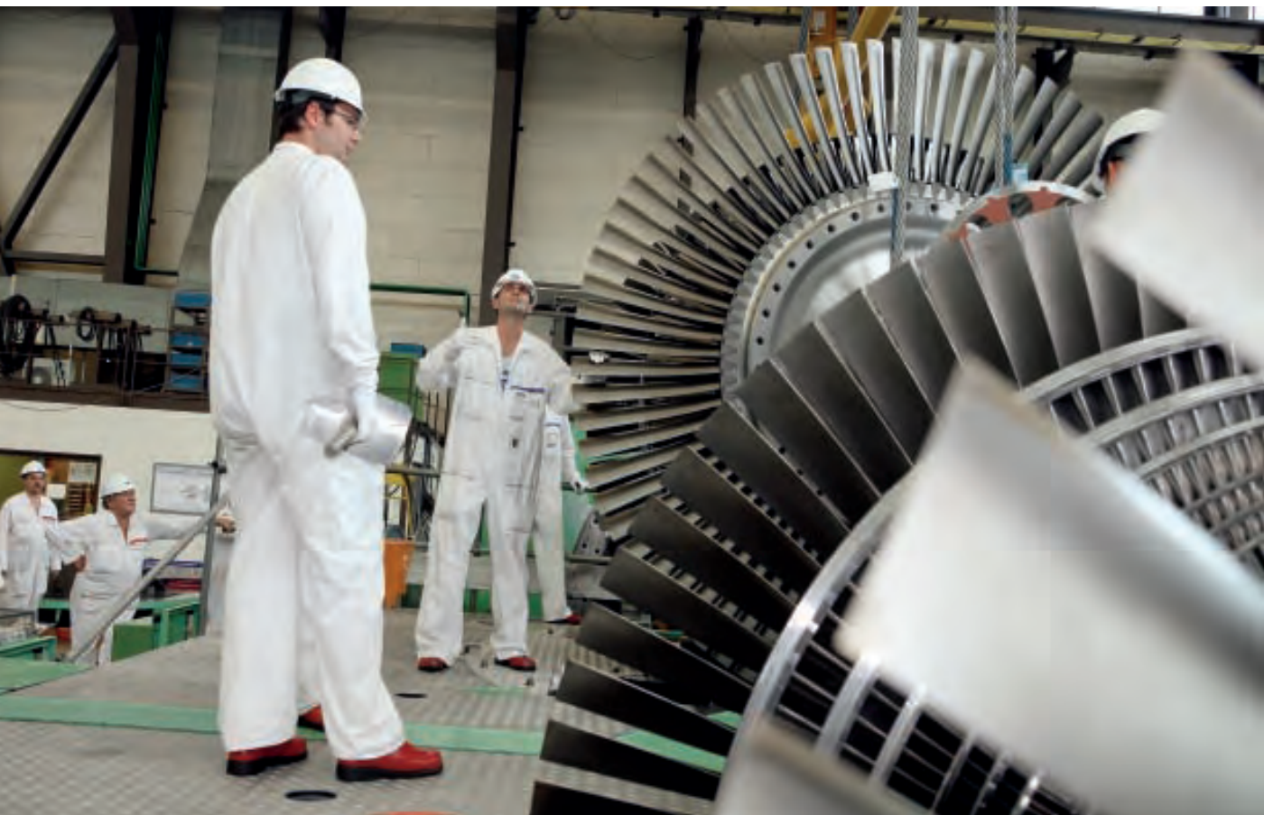
Revision einer Turbine Foto: KKM
