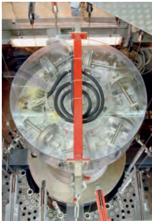
Blick in den PROTEUS-Reaktor mit der aufgesetzten Wechselflasche zum fernbedienbaren Einfahren von abgebrannten Brennstoffproben. Unter der Plexiglasschutzhaube sind die sechs Schrittmotoren zur vertikalen Positionierung der Proben zu erkennen. Konzentrisch sind 16 Steuer-, Sicherheits- und Abschaltstäbe angeordnet.
