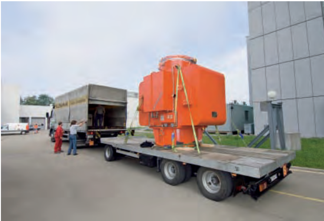
Abtransport eines Kondensatpumpen- motors zur Inspektion Foto: KKL
