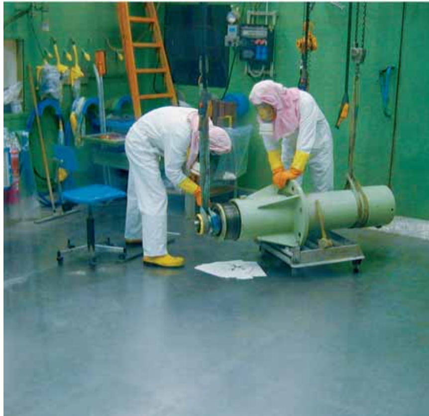
Austausch der 100-Tonnen- Presse zur Konditionierung radioaktiver Abfälle.
