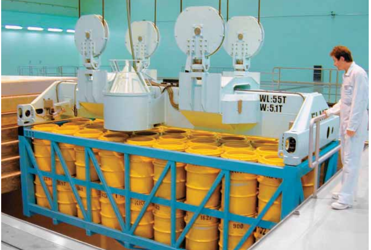
Gebinde mit konditionierten schwachaktiven Abfällen. Foto: ZWILAG
