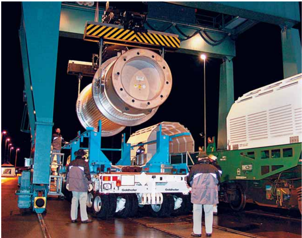
Umladen eines Transport- und Lagerbehälters von der Eisenbahn auf ein Strassenfahrzeug Foto: ZWILAG
