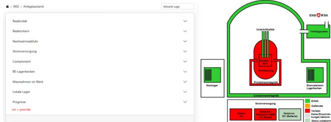
Darstellung 43: Liste der Systeme und Komponenten (links), deren Statusbeurteilung zur automatischen Einfärbung der Anlagengrafik (rechts) führt, am Beispiel des Kernkraftwerks Gösgen.
