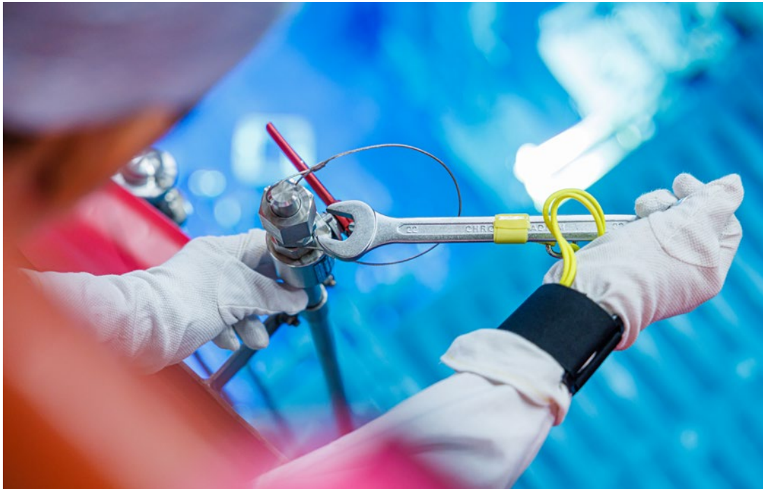
Bild 14: Sicherung von Werkzeugen gegen Fremdmiteintrag während der Jahresrevision.
