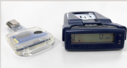
Bild 11: Personen, die bei ihrer Arbeit in Kernanlagen als strahlenexponiert gelten, müssen zwei verschiedene Dosis-Messgeräte tragen: Links im Bild ein passives Dosimeter, rechts ein aktives Dosimeter.
