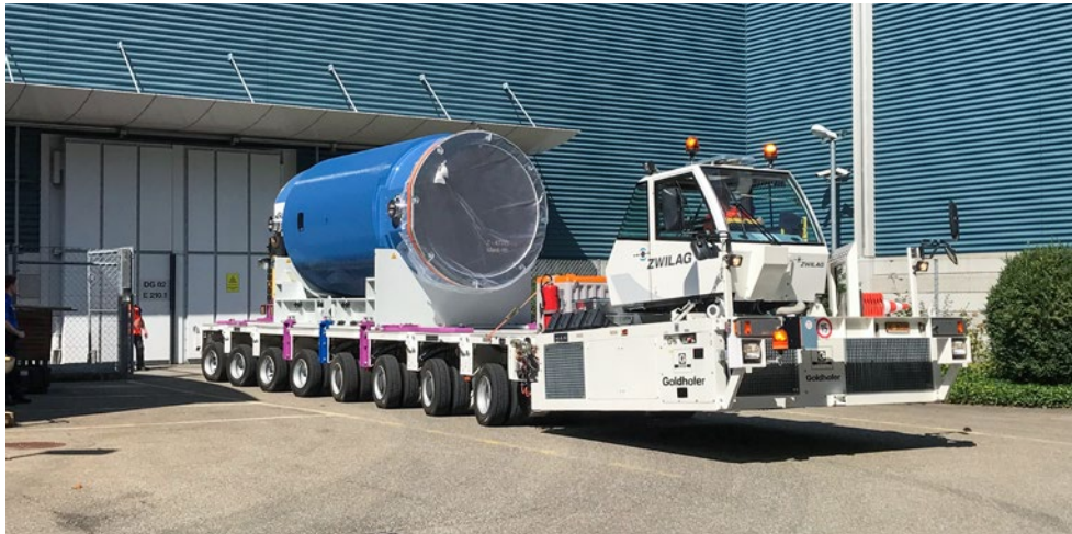
Anlieferung eines CASTOR®-Behälters. Foto: Zwilag
