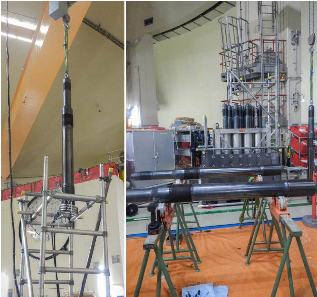
Bild 10: Prüfeinrichtung der RDB-Bolzen im KKG.
