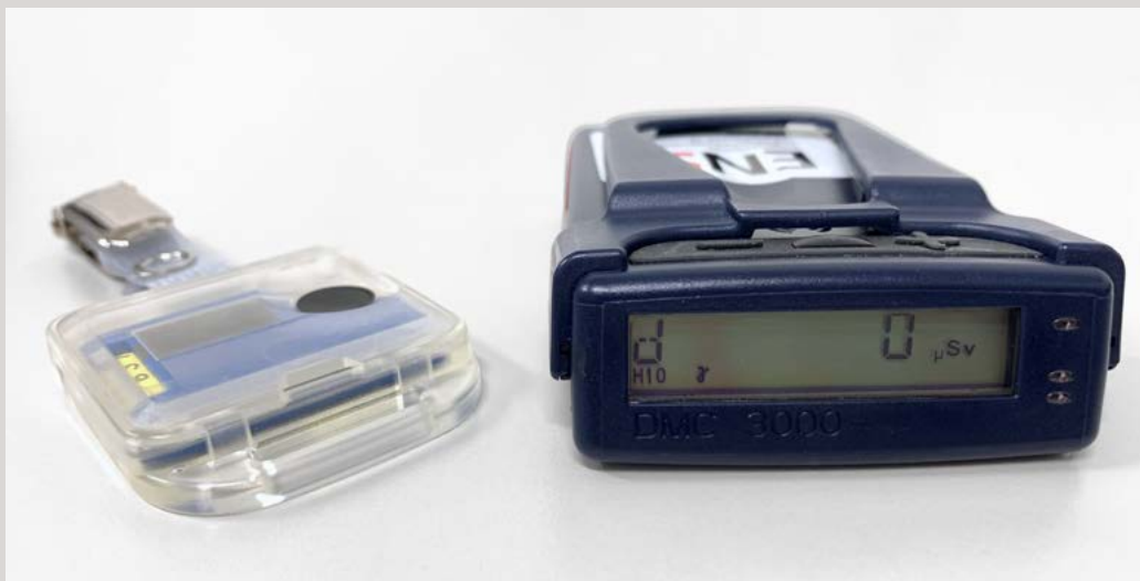
Bild 4: Personen, die bei ihrer Arbeit in Kernanlagen als strahlenexponiert gelten, müssen zwei verschiedene Dosis-Messgeräte tragen: Links im Bild ein passives Dosimeter, rechts ein aktives Dosimeter.
