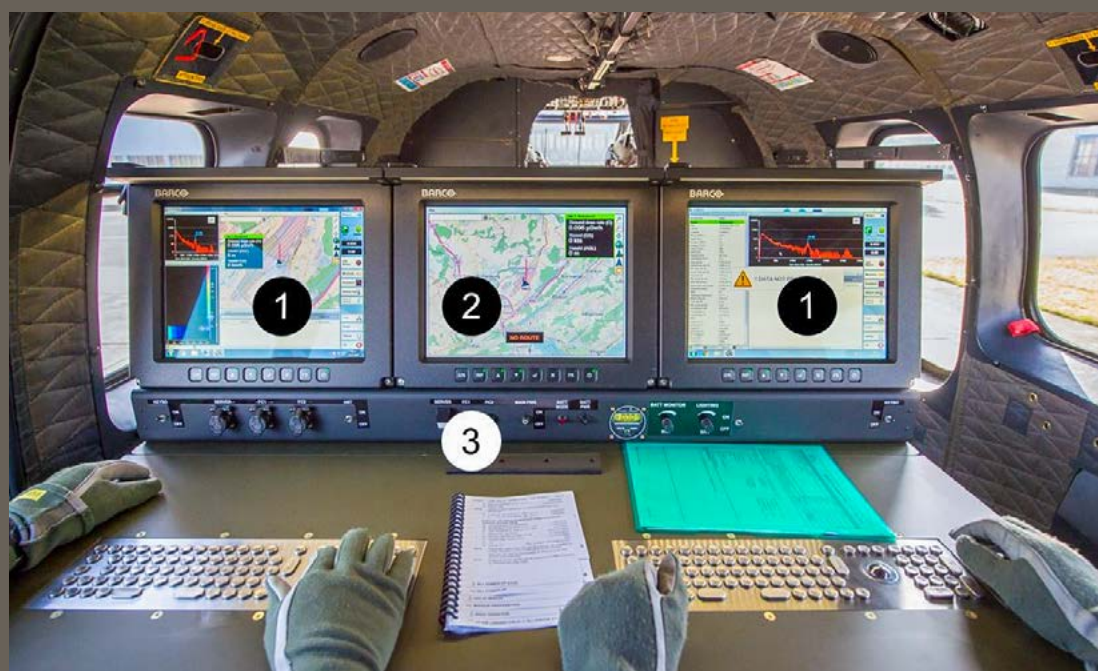
Bild 1: Bedienkonsole des schweizerischen Aeroradiometrie- systems. 1) Bildschirme der Benutzer- rechner; 2) gemein- samer Bild- schirm mit Spiegelung ins Cockpit; 3) Bedienleiste mit Schaltern für Strom- versorgung, Beleuchtung und Kommu- nikation sowie Schnittstellen für den Daten- transfer. Foto: Butterweck et al., 2024
