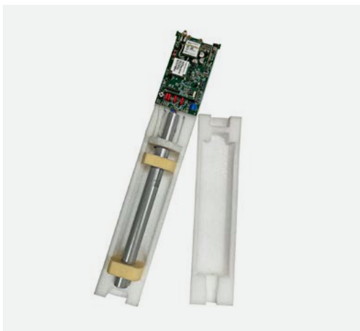
Bild 22: Komponenten eines Gamma-Tracer XL2 der Firma Bertin GmbH mit einem langen Niederdosiszählrohr und einem kurzen Hochdosiszählrohr sowie einem Elektronikmodul.
