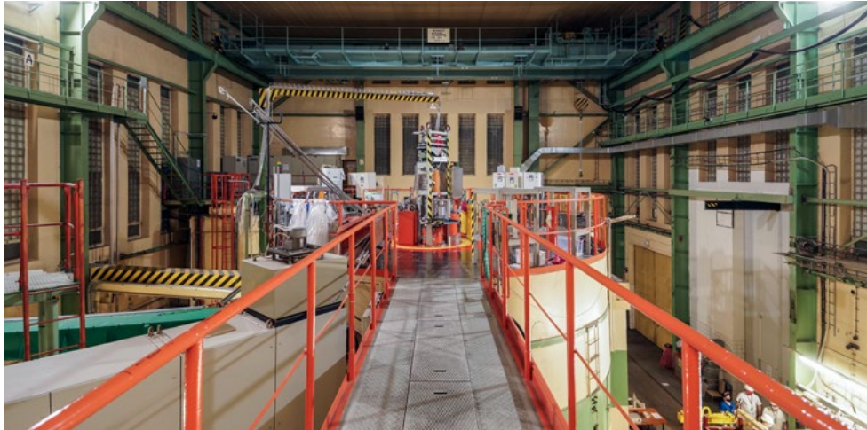
Abbildung 1: Der Reaktor LVR 15 im tschechischen Forschungsinstitut ÚJV Řež nahe Prag ist einer der Reaktoren, in dem Bestrahlungs- versuche im Rahmen des FIDES-Pro- gramms stattfinden. (Bild: Centrum výzkumu Řež)
