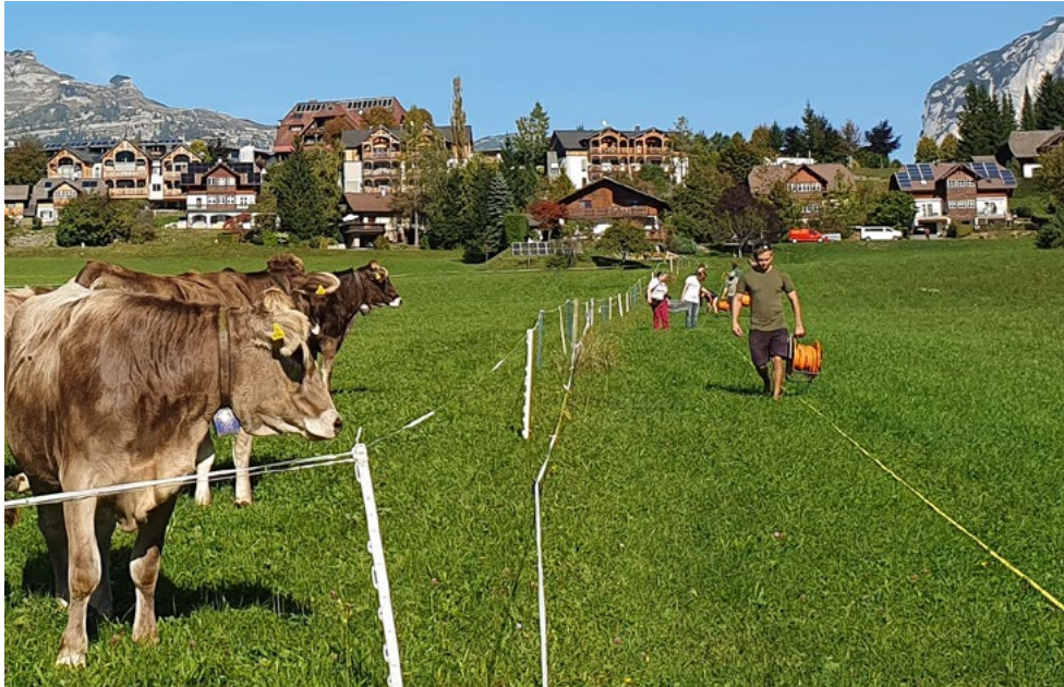
Abbildung 42: Geoelektrische Messungen im Oktober 2023 in Bad Aussee im steirischen Salzkammergut. Studierende der Universität Salzburg richten unter neugierigen Blicken eine Messanordnung zur Bestimmung des elektrischen Widerstands im Untergrund ein. Die Übertiefung von Bad Aussee reicht bis circa 1000 Meter unter die mit saftigem Gras bedeckte Geländeoberfläche. (Bild: C. Schmalfluss, Universität für Bodenkultur, Wien)
