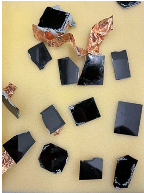
Abbildung 17: Verschiedene Kathoden aus Silikatglas mit niedrigem Widerstand. Das Glas ist beschichtet mit Karbonband und Kupferfolie. Die hellen Punkte entsprechen Ablagerungen durch Propanmoleküle und die hellgraue Substanz ist Abdichtungsknete. (Bild: Universität Zürich)
