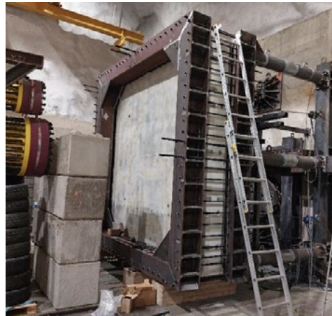
Abbildung 7: IMPACT IV – NEREID: Versuchseinrichtung für den Test GSX1-L mit einem geometrischen Skalierungsfaktor von 1,75. (Bild: VTT)
