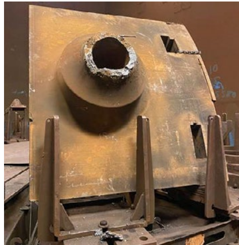
Abbildung 5: Entferntes Teilstück des Reaktordruckbehälters von Oskarshamn 2 mit dem Speisewasserstutzen; Gewicht: 1,8 Tonnen. Aus diesem Bauteil werden Materialproben für das Teilprojekt 2 gewonnen. (Bild: Oskarshamns-verkets Kraft-grupp AB)
