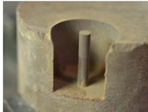
Abbildung 40: Vorbereitung der zylindrischen Proben für die NMR-Untersuchung durch die Universität Bern. (Bild: CLAYWAT-Abschlussbericht)
