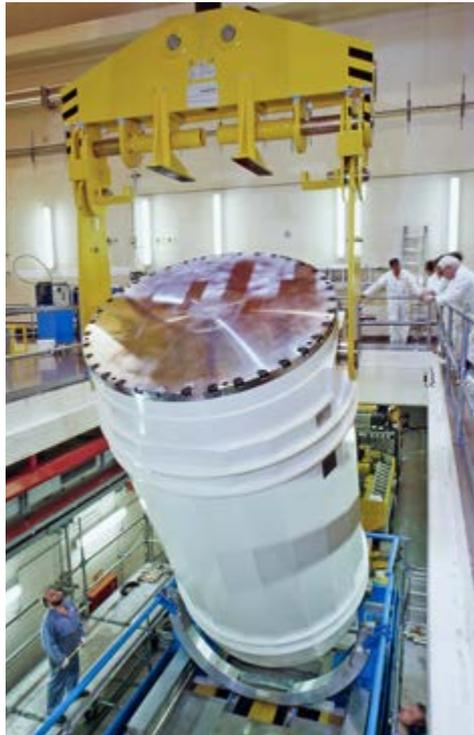
**Umladen eines Transport- und Lagerbehälters des KKL.
