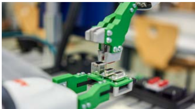
Bild 8: Links: Zweiarmiger, kollaborativer Roboter YuMi von ABB in der Smart Manufacturing Station zur Montage. Rechts: Zweiarmiger Roboter im Montageprozess.
