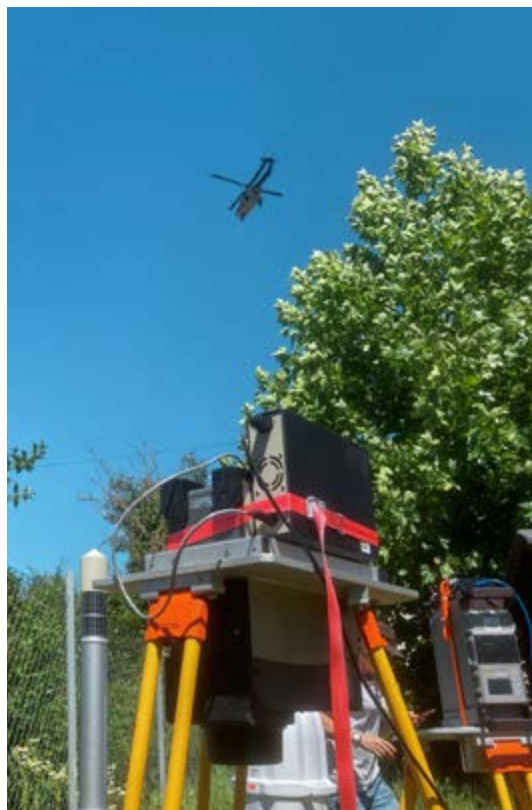
Bild 32: In-Situ-Mes- sung an MADUK- Standort und gleichzeitig stattfindender Aeroradiome- triemessflug.
