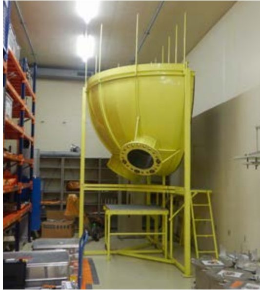
Bild 17: Dampferzeuger-Mockup zu Trainings- zwecken.
