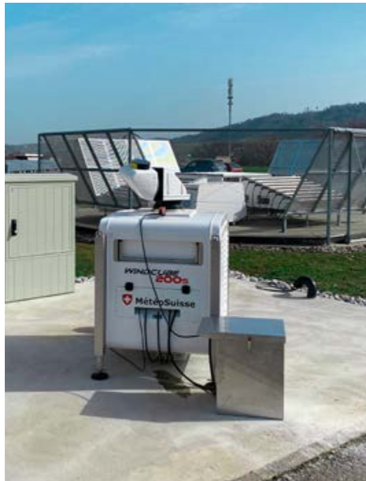
Bild 33: Messstation Payerne der MeteoSchweiz mit Doppler- LIDAR im Vordergrund und Wind- profiler im Hintergrund (Quelle: Meteo- Schweiz).
