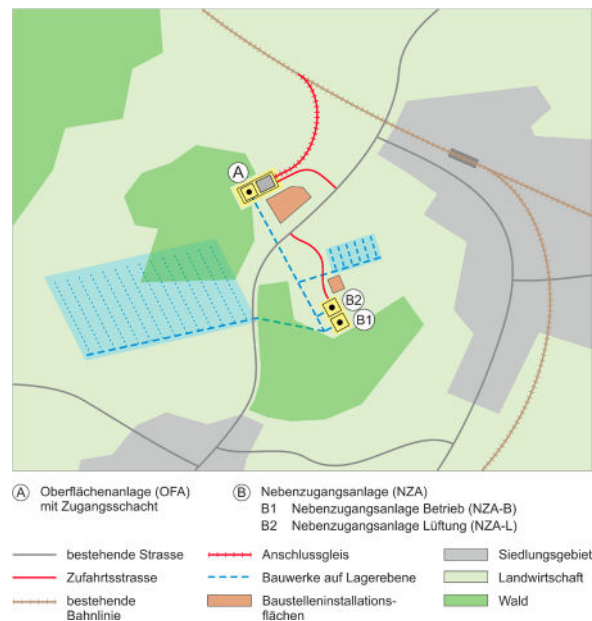
Abbildung 6: Schematische Anordnung der verschiedenen Anlagenelemente der Oberflächeninfrastruktur eines Kombilagers (NTB 21-01, Fig. 3.2-3).
