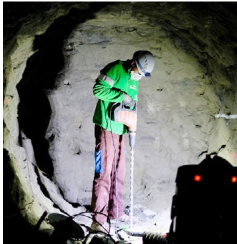
Abbildung 23: Im Rahmen des CD-A-Experiments werden von A. Degiacomi (swisstopo) Messpunkte für Präzisionsvermessungen installiert. Mit den geplanten Messungen sollen die vorhandenen Laserscan-Nivellements ergänzt werden. Bild: S. Schefer (swisstopo).
