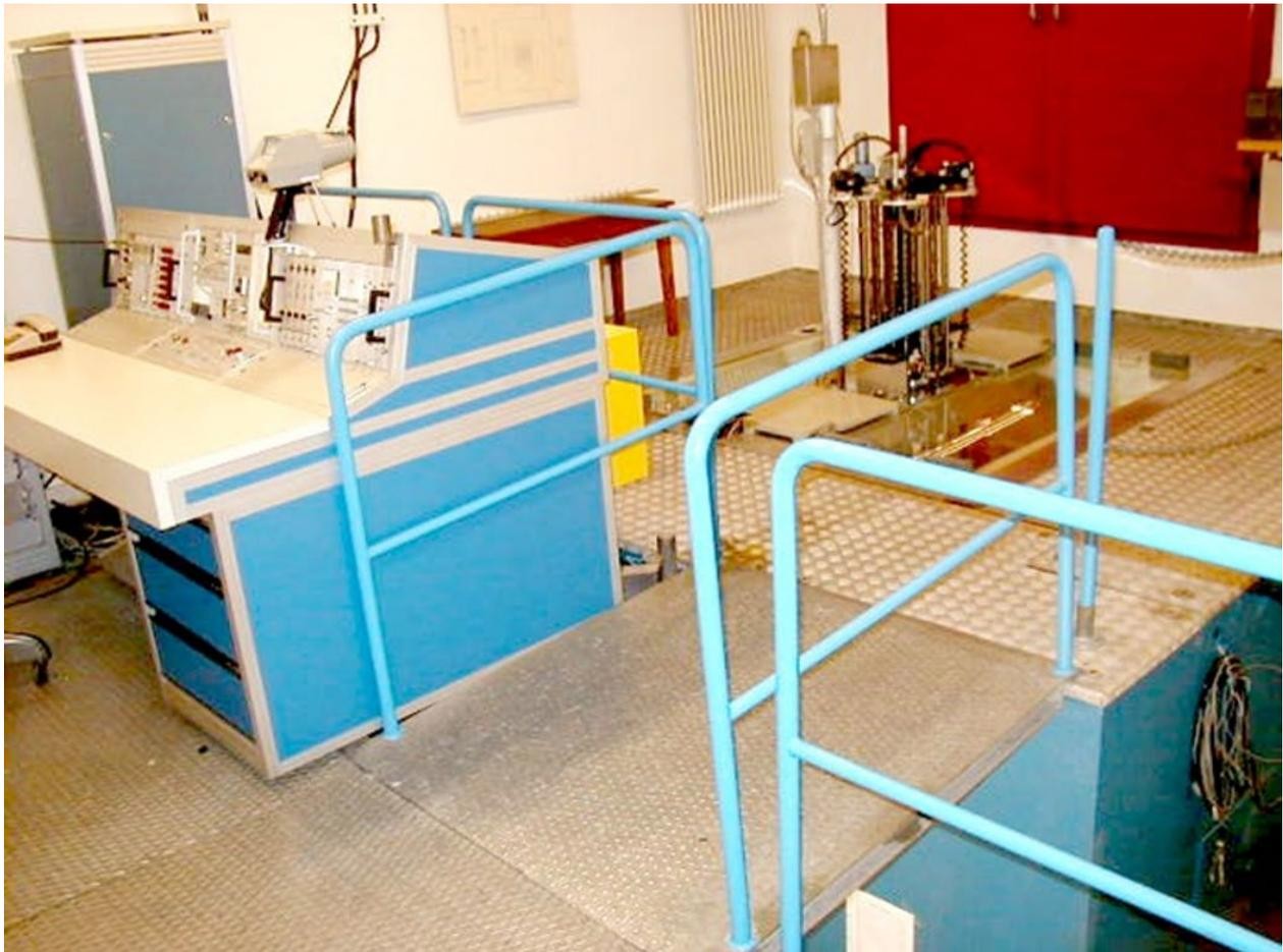
Abbildung 3-1: Zustand der Anlage vor Rückbaubeginn. Zu sehen sind der Reaktorblock mit eingelassenem Wassertank, die Steuerstabantriebe und das Kommandopult.
