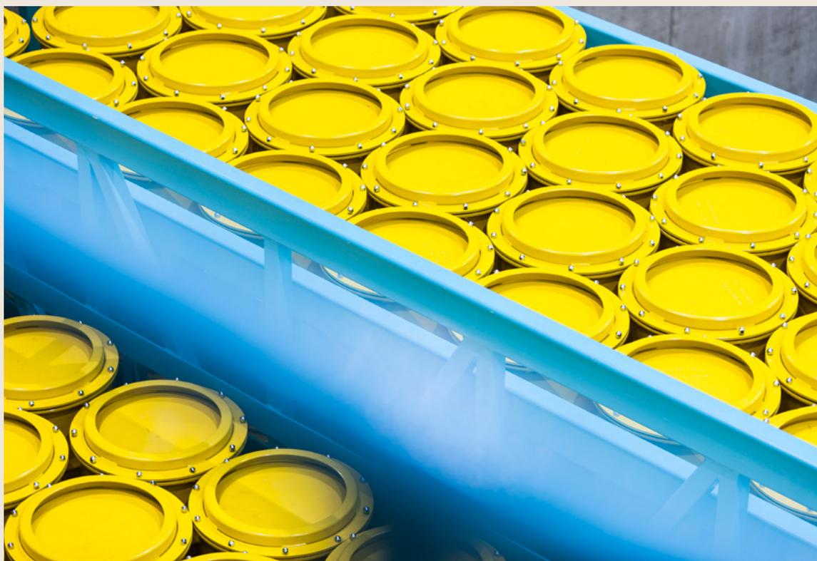
**Bild 13:** Schwach- bis mittelaktive Abfallgebinde in der Lagerhalle.
