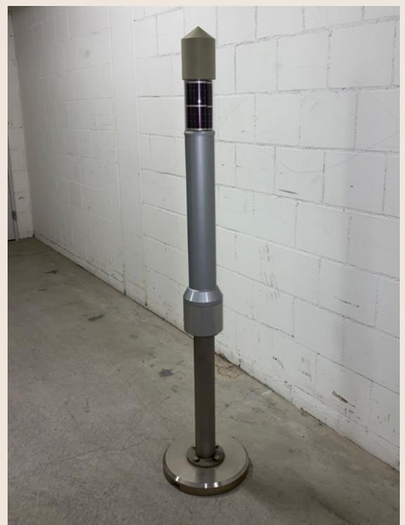
**Bild 18:** Neuer Sondentyp GammaTracer XL2 der Firma Bertin GmbH.
