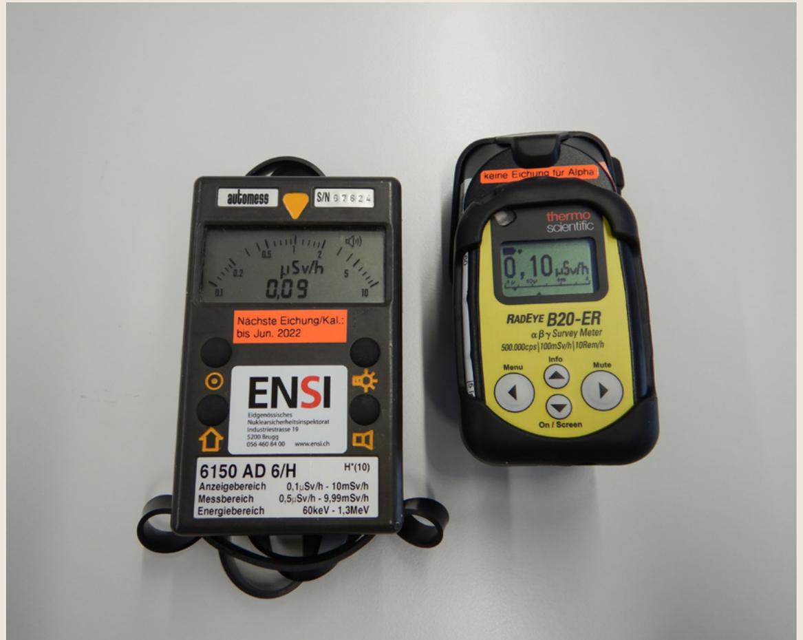
**Bild 2:** Dosisleistungsmessgerät Automess 6150 AD 6/H und RadEye B20-ER (zusätzlich noch als Kontaminationsmessgerät einsetzbar) wie sie vom ENSI in der Aufsicht verwendet werden.
