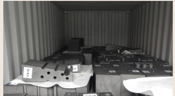
**Bild 12:** Zwischenlagerung von Grafitblöcken aus dem Rückbau des PROTEUS am PSI.
