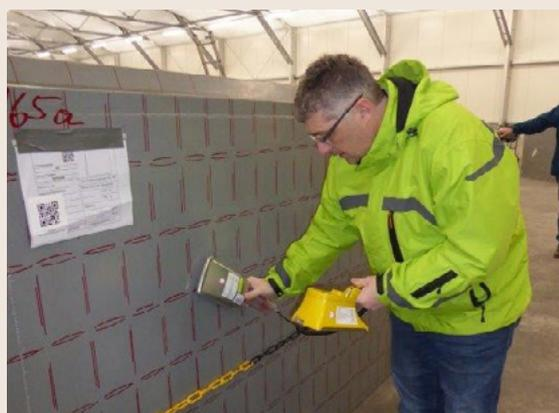
**Bild 15:** Mitarbeiter des ENSI bei einer Befreiungsmessung.
