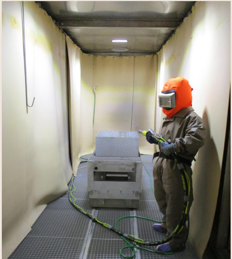
**Bild 1:** Inbetriebsetzung der Trockenstrahlanlage im KKM, mit der mittels abrasiver Methoden Komponenten aus dem Rückbau dekontaminiert werden sollen. Das Foto zeigt, wie im Caisson gearbeitet werden soll.
