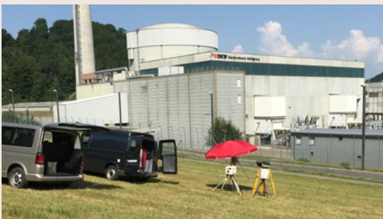
**Bild 19:** In-situ-gammaspektrometrische Messung aus dem Ergänzungsprogramm 2017–2019 beim KKM.
