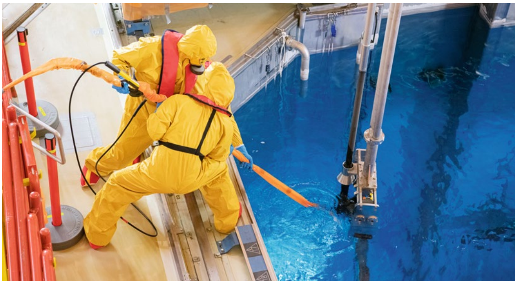
Neutronenflussmessung. Foto: KKG
