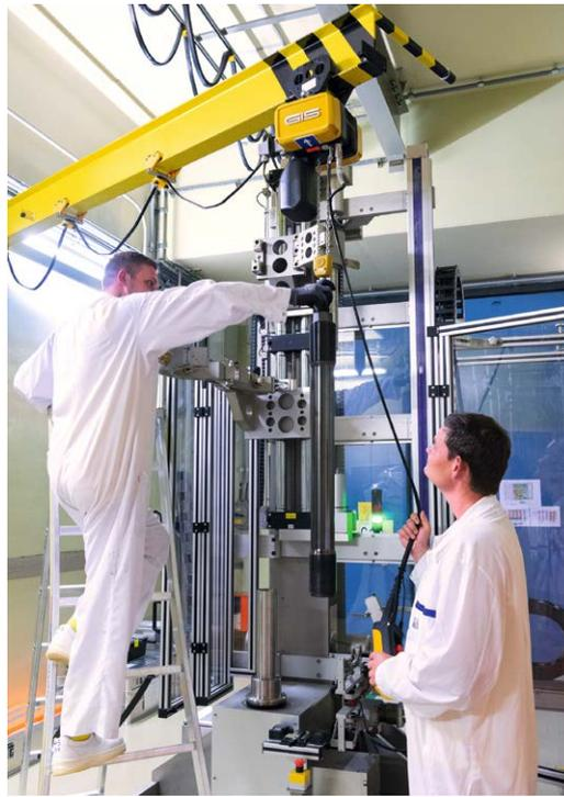
An der Bolzenprüfanlage für die Wirbelstromprüfung.
