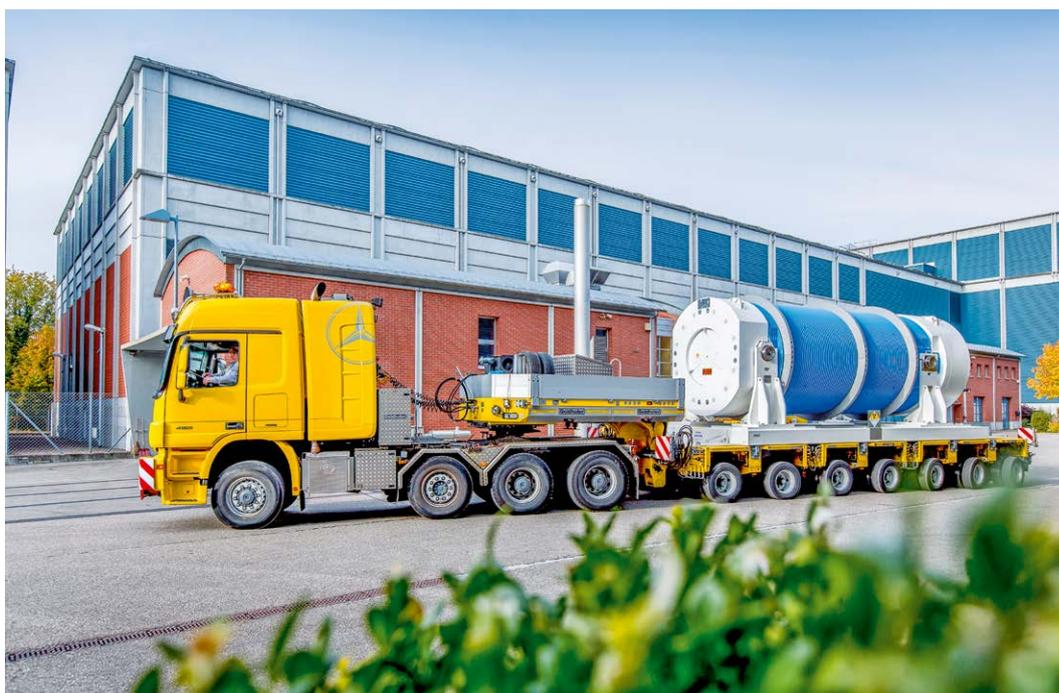
Schwerlasttransport eines Transport- und Lagerbehälters (TLB) von der Bahnstation in die Zwiilag.
