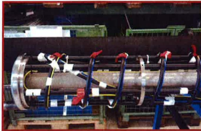
**Figur 9:** Zusammenstellung des Teststranges für das MO-Experiment mit den aufgewickelten verschiedenen Typen von Glasfaser-Kabeln (Quelle: swisstopo).
