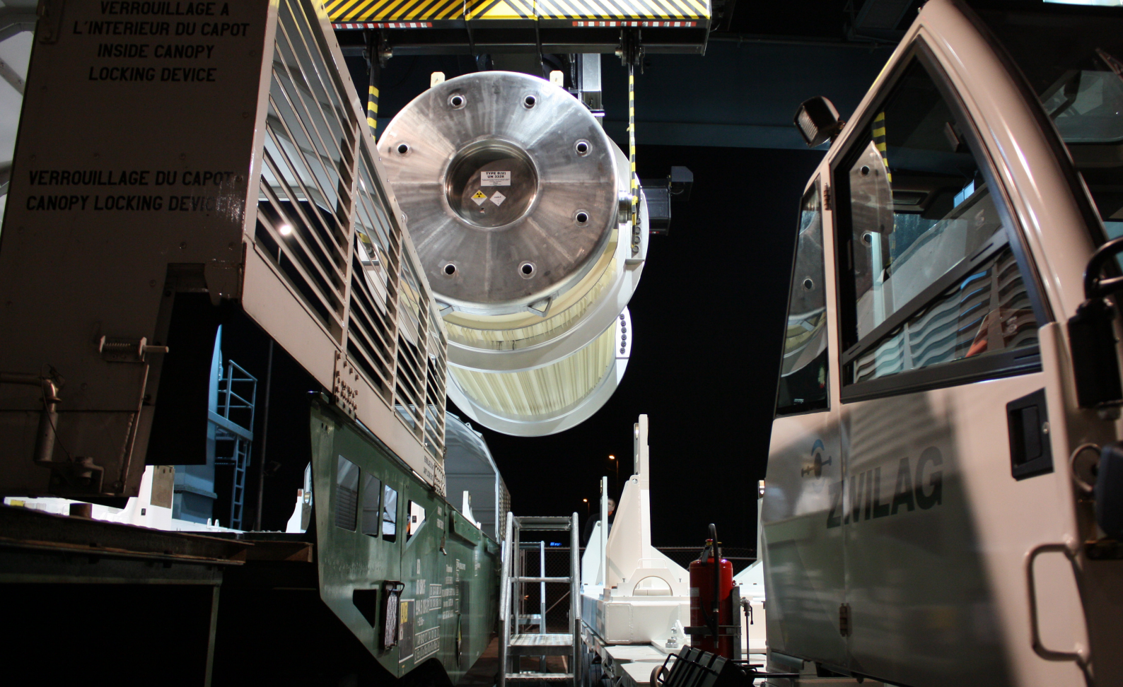
Bild: Behälter wird bei der Umladestation des Zwilag von einem Bahnwagen auf das Schwerlastfahrzeug umgeladen (Zwilag)
