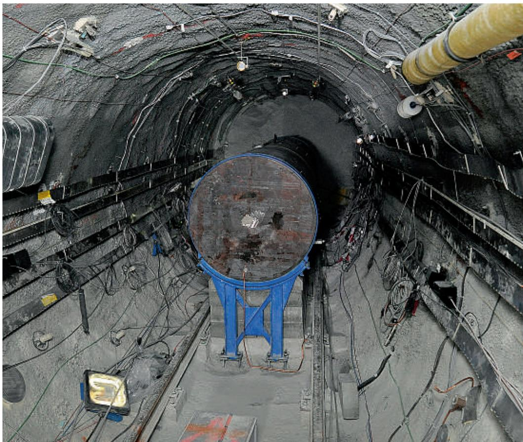
*Einbau des Testbehälters in den Versuchsstollen.
