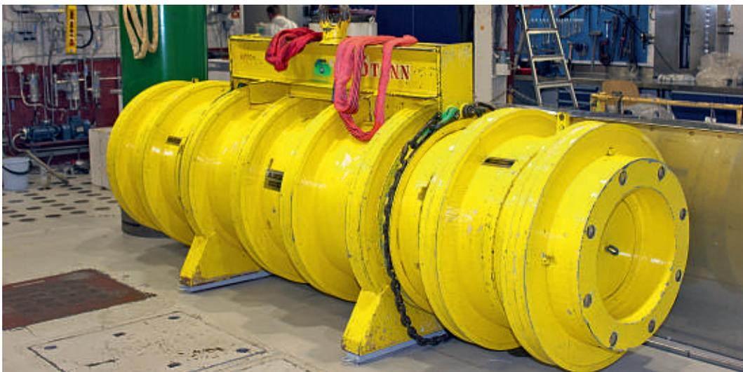
**Abbildung 2:** Im Halden-Reaktor werden auch Brennstab-Segmente untersucht, die bereits in Kernkraftwerken bestrahlt wurden. Sie werden in Behältern wie dem hier dargestellten nach Halden transportiert. Quelle: HRP.
