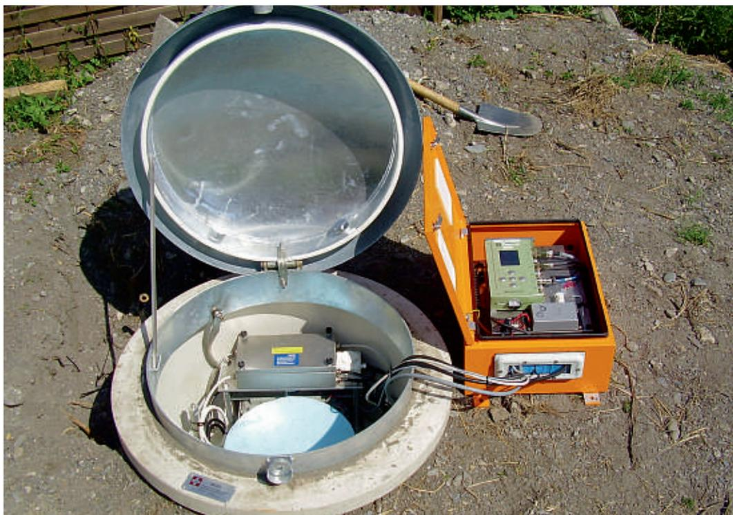
**Abbildung 14:** Eine moderne Starkbeben-Messstation. Das Bild zeigt die geöffnete Abdeckung der Freifeld-Installation. Quelle: SED, siehe auch unter <http://www.seismo.ethz.ch/monitor/>.
