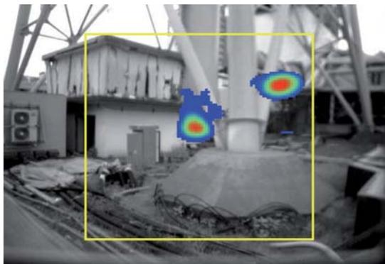
Abb. 3-6 Kaminfuss Blöcke 1 und 2, Aufnahme mittels Gamma-Kamera <sup>19</sup>
