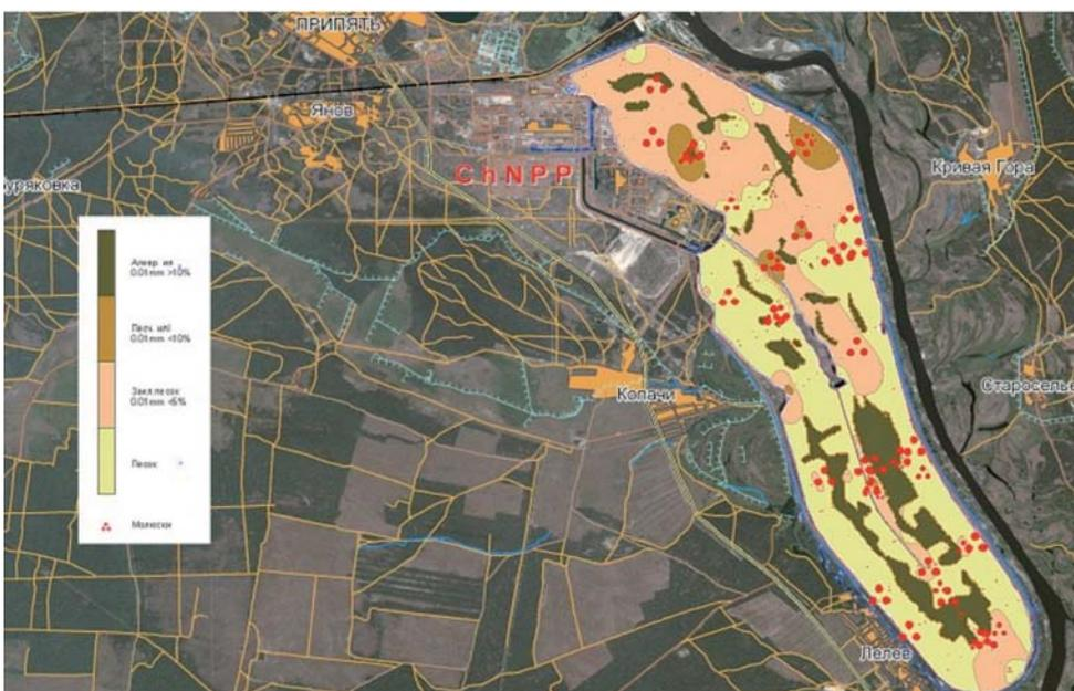
Abb. 7-4 Kühlteich am Kernkraftwerk Tschernobyl mit eingezeichneten Sedimenten<sup>59</sup>
