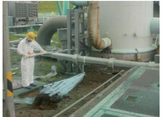
Abb. 3-7 Kaminfuss zwischen den Blöcken 1 und 2, Messung mit einem Teleskopdetektor <sup>20</sup>
