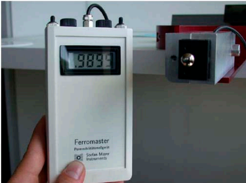
Abb. 43: Handprüfgerät zur Messung der magnetischen Permeabilität bestehend aus Sensor (Dauermagnet und Förster-Sonde) und Anzeigegerät
