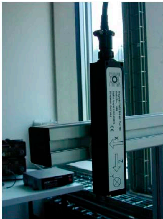
Abb. 44: Messanordnung des Restfeldverfahrens mit Fluxgate-Sensor, Manipulator und Messelektronik.
