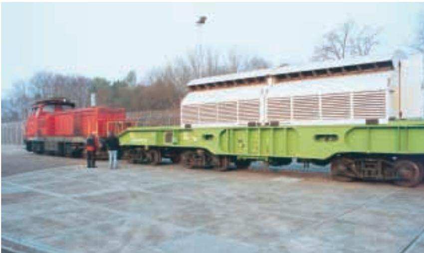
Anlieferung eines leeren Transportbehälters für abgebrannte Brennelemente auf dem Schienenweg
