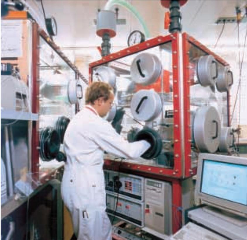
*Komplexe chemisch-physikalische Messmethoden wurden den Hotzellenbedingungen angepasst und stehen nun den Kernbrennstoffuntersuchungen zur Verfügung*
