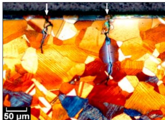
*Lichtmikroskopische Aufnahme eines Radialschliffs: Kurze, an der Oberfläche initiierte Risse wachsen ins Zentrum der Probe.*
