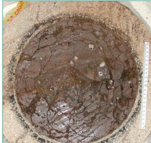
Bild einer aufgeschnittenen Probe, die eine erkaltete, in einen Betonzylinder gegossene Kernschmelze zeigt, die sich mit einem Teil des Betons vermischt hat.
