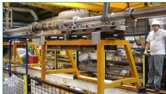
Bild 2: Die Testzelle vor dem Einbau in den CABRI-Reaktor.
