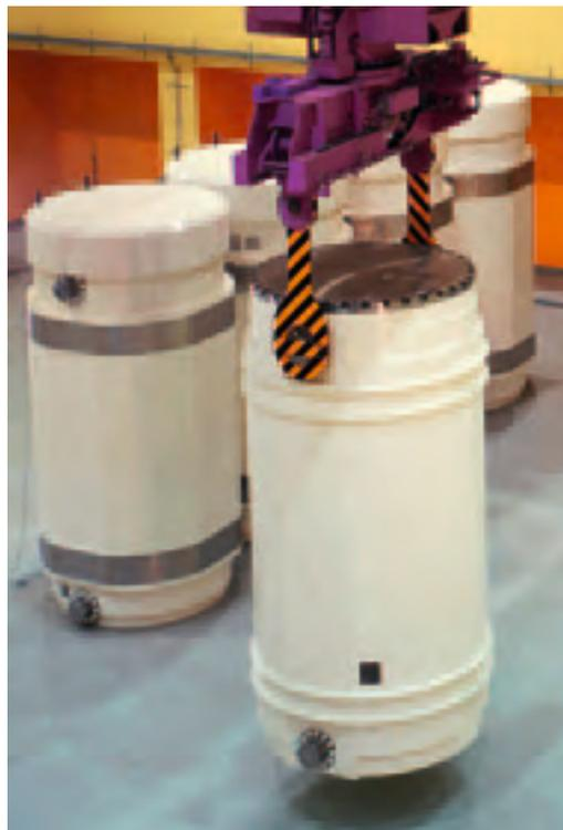
Ein Transport- und Lagerbehälter wird mit dem Kran in die Lagerhalle für hochaktive Abfälle gestellt.
