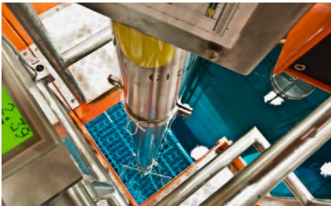
Brennelemente werden ferngesteuert im Kompaktlagergestell abgesetzt.
