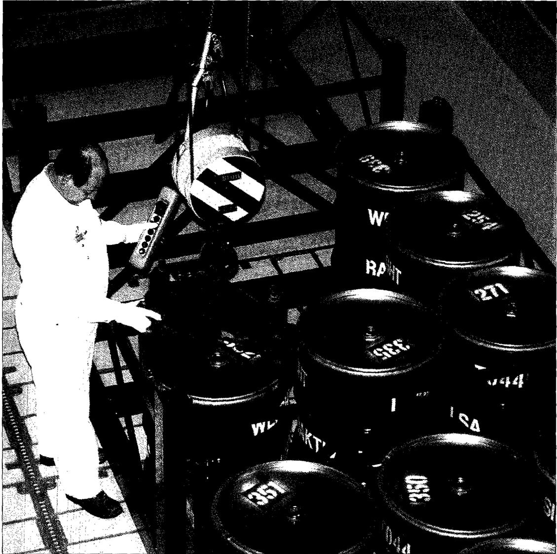
Fässer mit konditionierten schwachradioaktiven Abfällen
